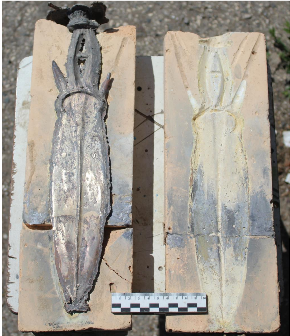
Фото № 16 Обработка кинжала после отливки
