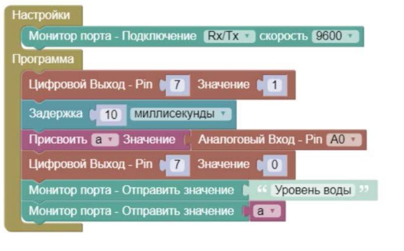
Рис. 4. Алгоритм определения влажности почвы
