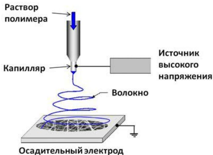
Рисунок 4 – Схема установки для электроформования (электроспиннинга)
