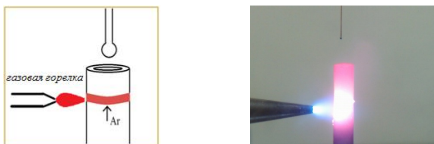
Рис. 1. Методика получения микросферы на торце халькогенидного волокна: схема (слева) и реализация (справа).
