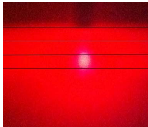
Рис. 8 Распространение флуоресценции внутри фантома при использовании красного фильтра
