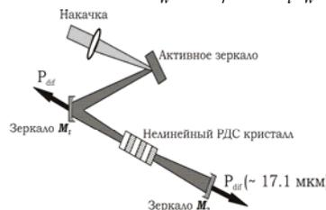
Рис.1. Схема двухчастотного ЛВВР
