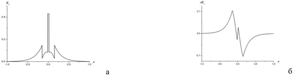
Рис. 3. Поперечные профили компонент электрического поля ТМ-мод щелевого волновода:  $E_x$  (а) и мнимой части  $E_z$  (б). Длина волны  $\lambda = 1,55$  мкм, ширина сердцевины  $a = 0,1505$  мкм, показатель преломления сердцевины  $n_{co} = 3,47$  (Si), показатель преломления оболочки  $n_{cl} = 1,527$  (SiO<sub>2</sub>), амплитуда  $A=1$ .
