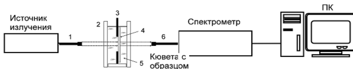
Рис. 1. Схема экспериментальной установки для регистрации спектров коллимированного пропускания:
