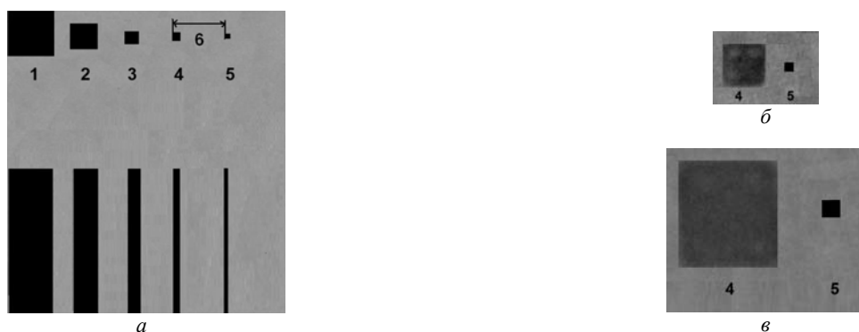
Рис. 4. Фотошаблон: a – общий вид (объектив - 10\times ), размеры частиц: 1 – 100 мкм, 2 – 50 мкм, 3 – 10 мкм, 4 – 5 мкм, 5 – 1 мкм; расстояние между соседними частицами 6 – 100 мкм; б – «микрочастицы» 4 и 5 для 40\times объектива, в – «микрочастицы» 4 и 5 для объектива - 90\times
