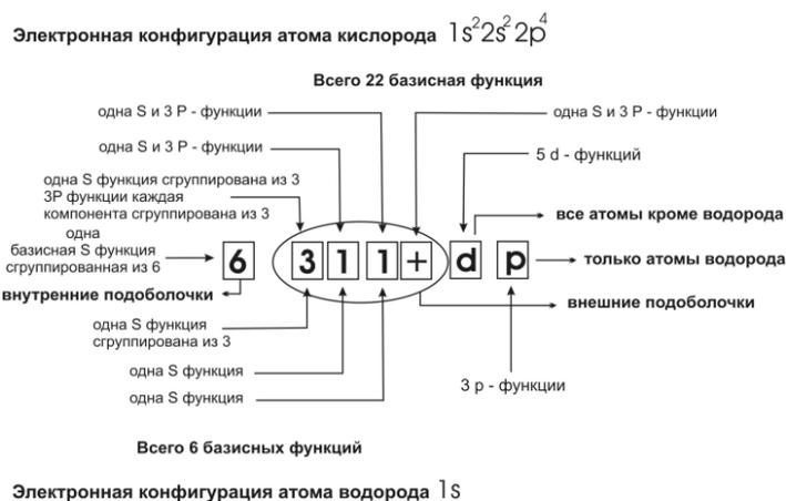
Рис.1. Расшифровка базисного набора 6-311+G(d,p) применительно к описанию атомов кислорода и водорода.
