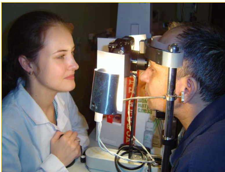
Рис. 8. Экспериментальная установка для регистрации in vivo цифровых изображений радужной оболочки
