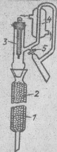
Рис. 10. Ректификационная колонка: 1 - насадка; 2 - изоляция; 3 - термометр; 4 - обратный холодильник; 5 - кран для регулируемого отбора конденсата
