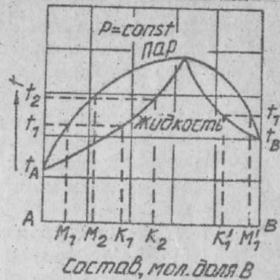
Рис. 5. Диаграмма температура кипения - состав бинарной смеси с максимумом температуры кипения
