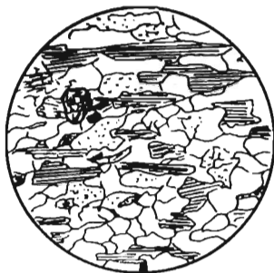
Рис. 49. Лепидогранобластовая структура. Порода сложена преимущественно полевыми шпатами и кварцем, незначительное количество листочков биотита располагаются субпараллельно. Преобладают зерна размером 0,5-0,8 мм ( d=2 мм, без анализатора)
