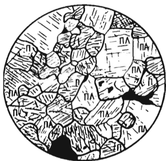
Рис. 36. Габбровая структура. Пл — плагиоклаз; П — пироксен, черное — магнетит (мелкозернистое габбро, d = 2,5 мм, без анализатора)
