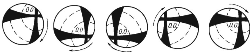
Рис. 15. Интерференционная фигура одноосного кристалла в косом разрезе (стрелками показано направление вращения столика микроскопа)
