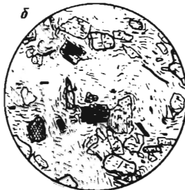
Рис. 40. Порфирировые структуры эффузивных пород (по А.Н. Заварицкому).
