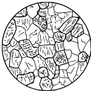
Рис. 48. Мозаичная структура пироксенового кристаллосланца. Зерна пироксена (высокий рельеф, спайность) и полевого шпата имеют изометричную форму с почти прямолинейными ограничениями ( d=2 мм, без анализатора)
