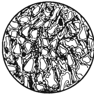
Рис. 54. Бластосаммитовая структура. Хорошо видны обломочные зерна кварца остроугольной или угловатой формы. Цемент исходного песчаника полностью перекристаллизован и превратился в агрегат субпараллельно ориентированных чешуй серицита, мусковита, хлорита и других минералов ( d=1,5 мм, без анализатора по Ю.И. Половинкиной)
