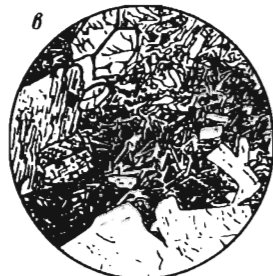
Рис. 40. Порфирировые структуры эффузивных пород (по А.Н. Заварицкому).
