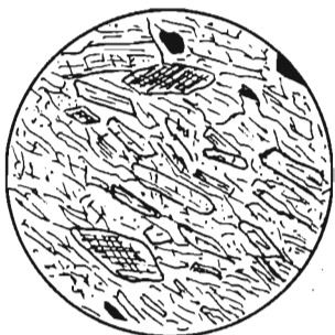
Рис. 50. Нематобластовая структура. Порода почти целиком сложена одинаково ориентированными кристаллами амфибола удлиненной формы ( d=2,5 мм, без анализатора)
