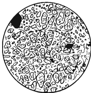
Рис. 21. Петельчатая структура разрушения оливина. Черное — рудный минерал ( d \approx 3 мм, с одним николем)
