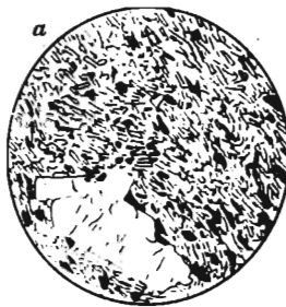
Рис. 40. Порфирировые структуры эффузивных пород (по А.Н. Заварицкому).
