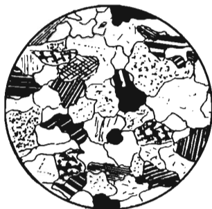
Рис. 47. Гранобластовая структура мелкозернистого биотит-плагиоклазового гнейса ( d = 2 мм, с включенным анализатором, по Ю.И. Половинкиной)
