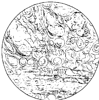
Рис. 6. Перлитовая структура в стекловатой породе. При одном никеле. Видны потоки кристаллитов (по Е. А. Кузнецову, 1970).
