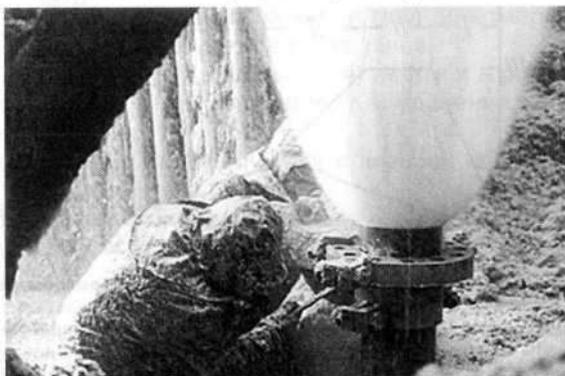
*Рис. 2.11. Газовый фонтан (без возгорания)*
