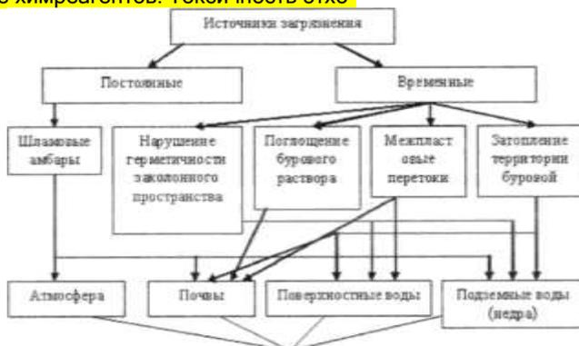
Рис. 2.5. Источники загрязнения при бурении скважин
