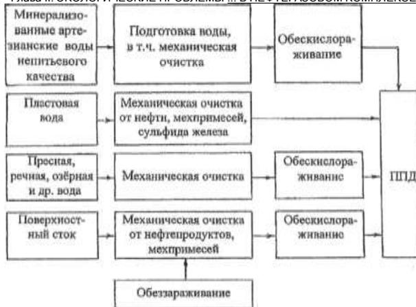
Рис. 2.18. Блок-схема водоснабжения системы заводнения
