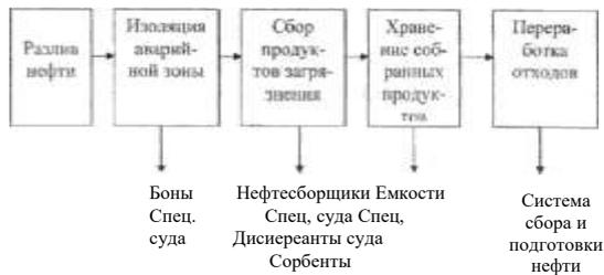
Рис. 2.23. Схема ликвидации разливов нефти на воде
