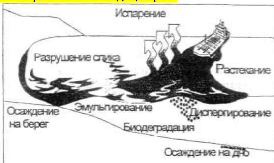
Рис. 2.34. Поведение разлитой нефти на воде
