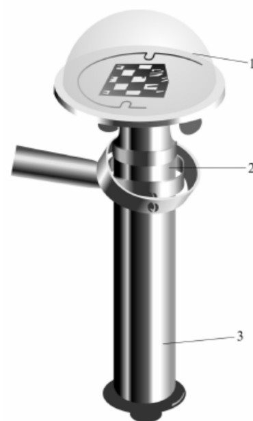
Рисунок 8.5 - Альбедометр походный М-69
