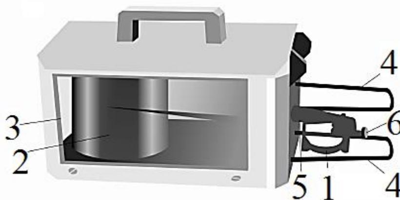
Рисунок 4.4 - Термограф метеорологический М-16АС
