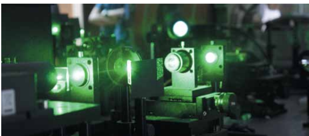
Единственная (в такой конфигурации) в России установка мандельштам-бриллиэновской спектроскопии позволяет исследовать магнитные наноструктуры
