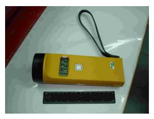
Основные технические характеристики: Чувствительность: 1·10<sup>-5</sup> (ед. СИ) Диапазоны измерений с автоматическим переключением уровня точности: (9,99; 99,9; 999) от -999 до 9999·10<sup>-3</sup> (ед. СИ) Рабочая частота: 10 кГц Сохранение данных до 70 измерений Источник питания: напряжением 9 В Рабочая температура: от -10°C до +55°C Размеры (диаметр х длина): 65 мм х 187 мм Вес, включая источник питания 0,35 кг
