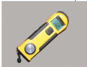
Основные технические характеристики: Чувствительность: 0,000001 единиц СИ Диапазон измерения: 0,000001...0,99999 единиц СИ с автоматическим переключением диапазонов измерения
