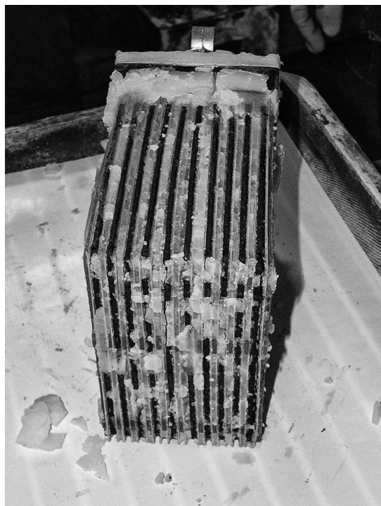
Рис. 4. Внешний вид электродного блока аккумулятора с баком из термоэластопласта после испытаний на воздействие внешнего гидростатического давления
