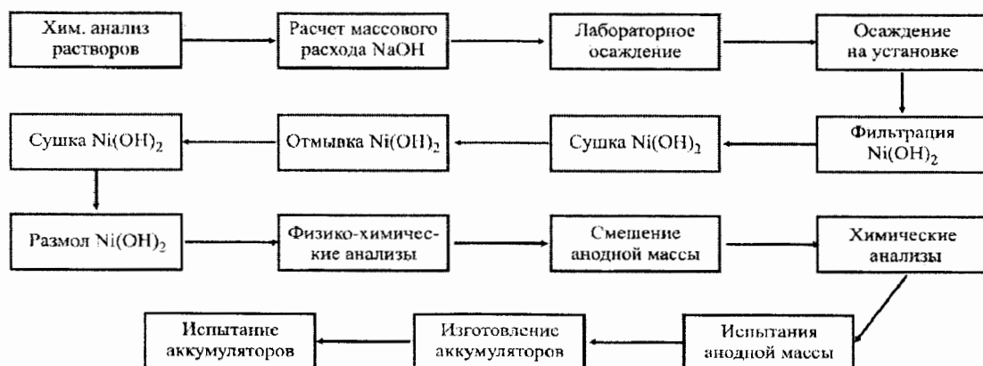
Рис. 1. Блок-схема методики исследований физико-химических и электрохимических свойств \text{Ni(OH)}_2 в зависимости от условий осаждения
