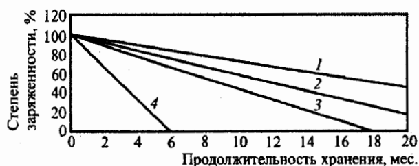
Рис.3. Изменение состояния залитых батарей в процессе хранения: 1 – РАС, 2 – гибридные, 3 – Pb-Sb 2.5%, 4 – Pb-Sb 5.5%
