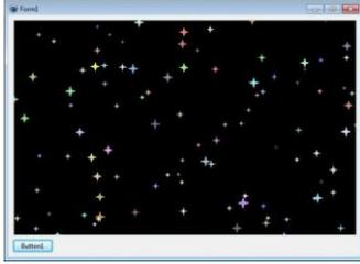
Процедура **Star** объявлена внутри класса **TForm1** и по сути является методом этого класса, позволяющим рисовать звезды на форме. При создании процедуры удобно использовать горячие клавиши (Ctrl-Shift+C), которые автоматически создадут тело процедуры внутри блока **implementation**. Для этого необходимо прописать заголовок процедуры в разделе **public** или **private** и нажать горячие клавиши Ctrl-Shift+C.
