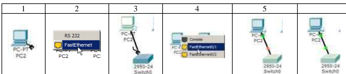
Рис. 4.10 Подключение PC2 к Switch0
