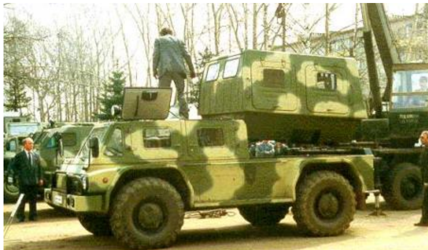
Рис. 23. Бронированный медицинский транспортёр (БММ-1). Предназначен для поиска, сбора и эвакуации раненых и пострадавших с места ранения и очагов массовых потерь.
