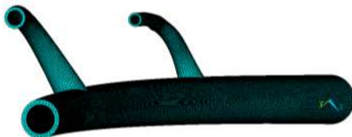
Рисунок 9.12 – Модель стенки сосуда, разбитой конечно-элементной сеткой.
