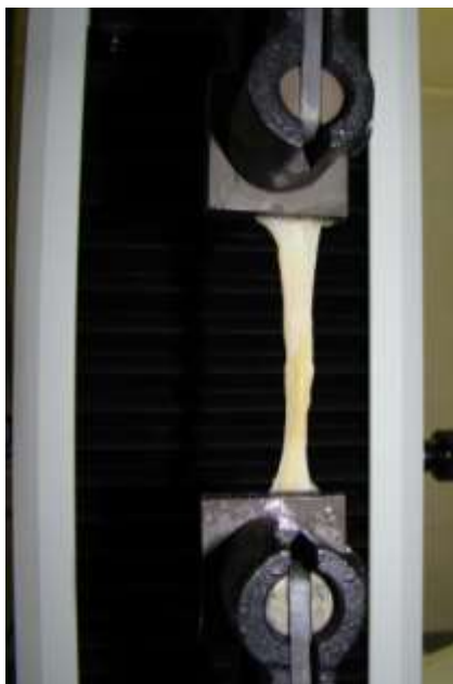
Рисунок 7.9 – Крепление образца в разрывной машине.
