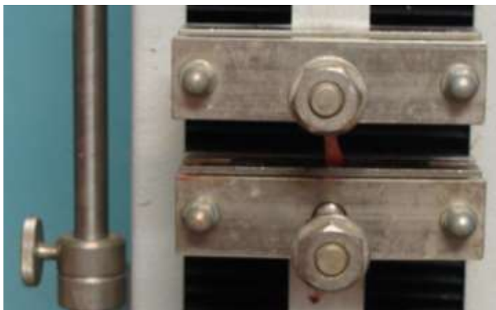
Рисунок 7.3 – Разрывная машина с закрепленным образцом растягиваемой артерии.
