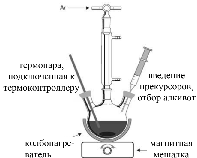
Рис. 1 Схема установки для проведения синтеза КТ
