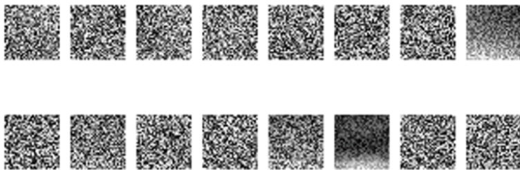
Рис. 4 — Фильтры, полученные из нижнего слоя сверточной нейронной сети после обучения. Свертки размером 32x32 были приняты как оптимальные с точки зрения обеспечения приемлимого рецептивного поля для захвата ФРТ со всего изображения и позволяющие проводить обучение относительно быстро. Видно, даже на взгляд их форма не соответствует требуемой
