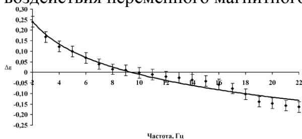
Рис. 6. Зависимость изменения диэлектрической проницаемости раствора соли сульфата меди (II) от частоты воздействия переменного магнитного поля
