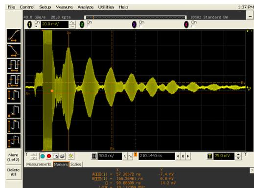
Рис.8. Осциллограмма эхоимпульсов ОСВ в пленочном ЖИГ резонаторе.
