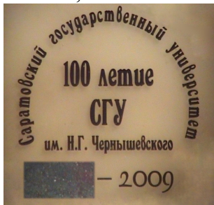
Рис. 14 Фотография пластины с юбилейным знаком СГУ, фрагмент которого покрыт слоем графита
