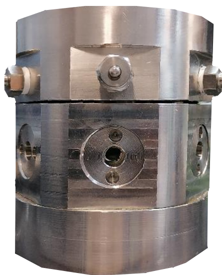
Рисунок 2.3. Многооконный реактор высокого давления.
