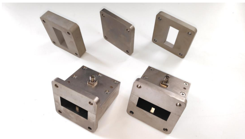
Рисунок 2.15. Коаксиально-волноводные переходы для канала 19,0 \times 9,5 мм (нижний ряд) и используемый для их измерения набор мер фазового сдвига и короткого замыкания (верхний ряд)
