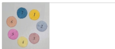
Рис. 6.1. Тест-устройство и схема расположения индикаторных зон в тест-устройстве. 1– рН, 2–сульфаты, 3– щелочность, 4– рН1, 5– рН2, 6– хлориды, 7– жесткость.
