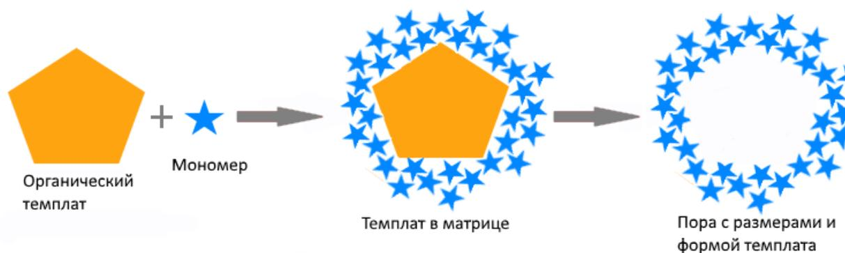
**Рис. 5.** Схема темплатного синтеза.
