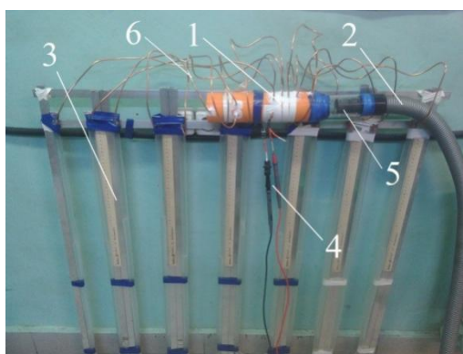
Рисунок 3.19. Экспериментальная установка [71]. 1 – турбина, 2 – шланг пылесоса, 3 – U – образный манометр, 4 – щупы осциллографа, 5 – устройство регулировки массового расхода газа, 6 – медные трубки манометров
