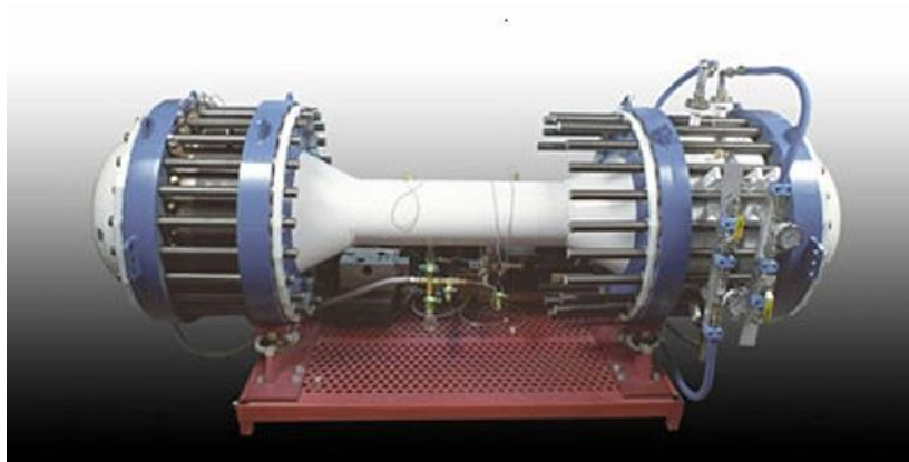
Рисунок 1.30 - Термоакустический холодильник со стоячей волной Triton C-10с. Государственный инженерный колледж Пенсильвании
