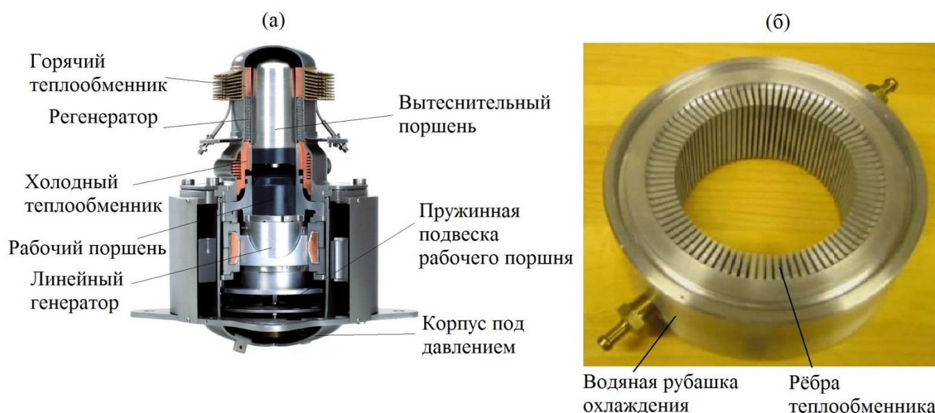
Рисунок 1.24 - Свободнопоршневой генератор Стирлинга компании Microgen engine corporation электрической мощностью 1 кВт [28]. (а) - генератор Стирлинга в разрезе, (б) – кольцевой пластинчатый теплообменник, аналогичный тому, что используется в двигателе компании Microgen
