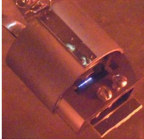
Рисунок 3.6. Катодное свечение при автоэмиссионном токоотборе 1450
