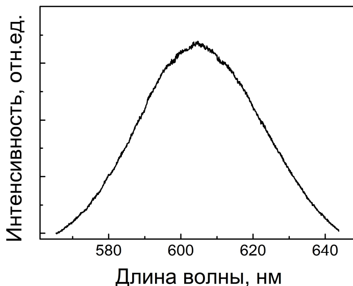
Рисунок 5.7 – Спектр фотолюминесценции образца \text{TlGaSe}_2 (образец N91), легированного бором (1%). Температура комнатная.
