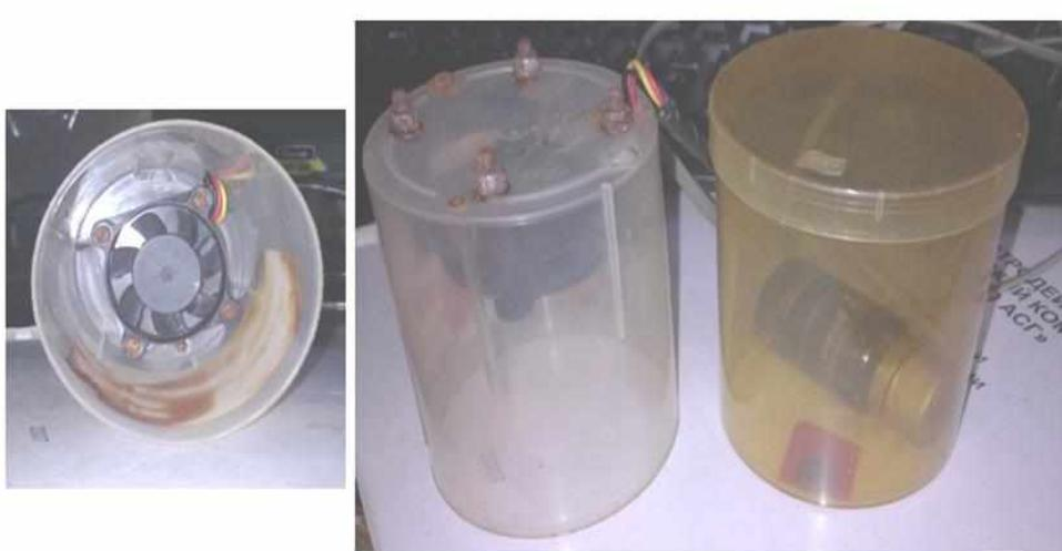
Рисунок 2.2 Реакционная камера для получения слоев иодистого серебра
