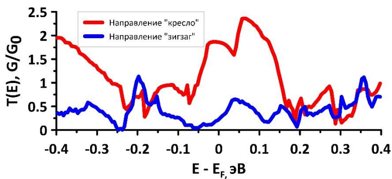
Рисунок 3.5 – Функции T(E) супер-ячеек композита графен/ОУНТ в направлениях «кресло» и «зигзаг» а) модель с ОУНТ (5,5); б) модель с ОУНТ (6,6); в) модель с ОУНТ (9,0); г) модель с ОУНТ (9,9)
