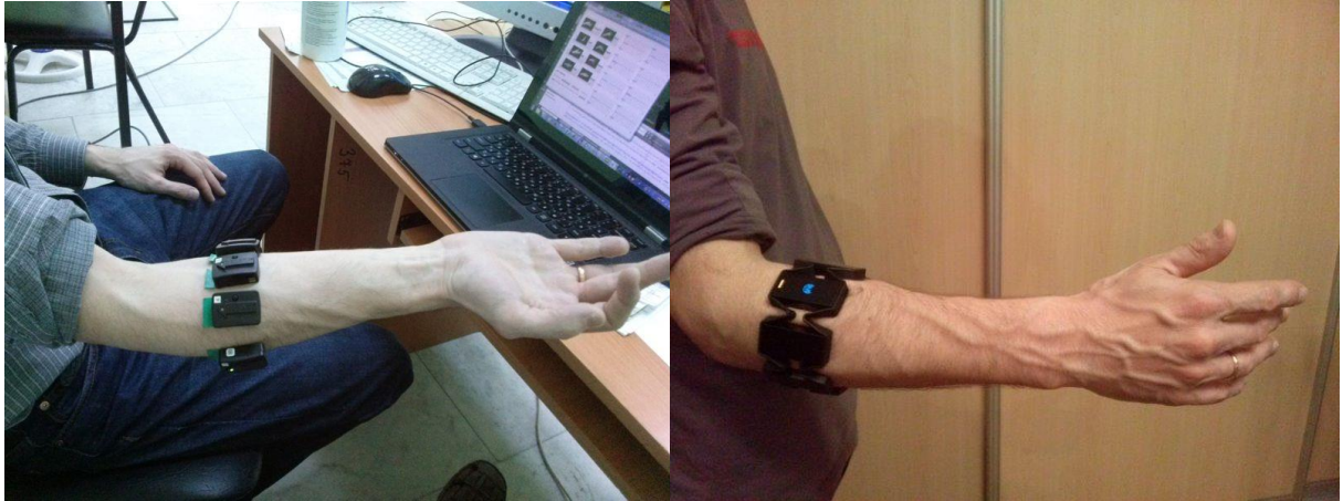
Рисунок 78. Расположение электродов в задаче классификации ЭМГ-паттернов: беспроводные датчики миографа DELSYS® Trigno™ (слева) и браслет MYO™ Thalmic (справа).
