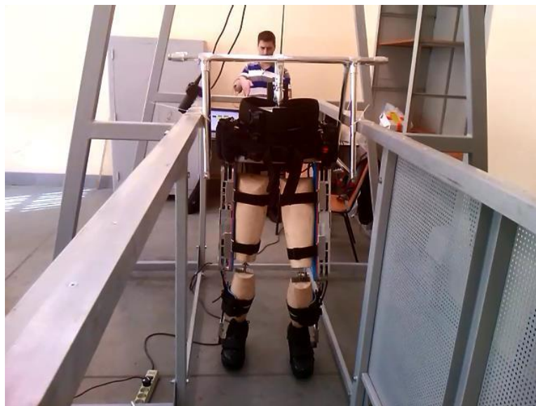
Рисунок 90. Управление экзоскелетонным комплексом, установленным на стенде. Представлен пример явного управления с помощью статических жестов руки.
