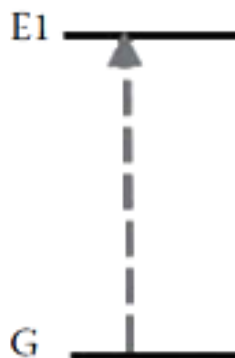
Рисунок 1 – Схема поглощения из основного состояния (GSA)
