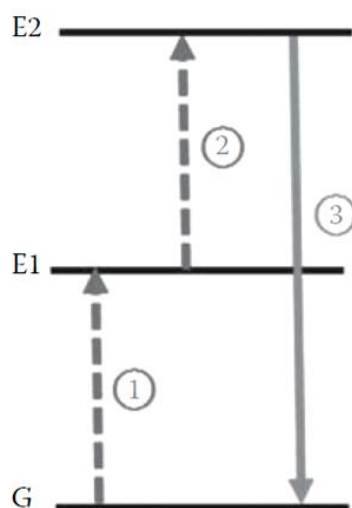
Рисунок 2 – Схема поглощения из возбужденного состояния (ESA)
