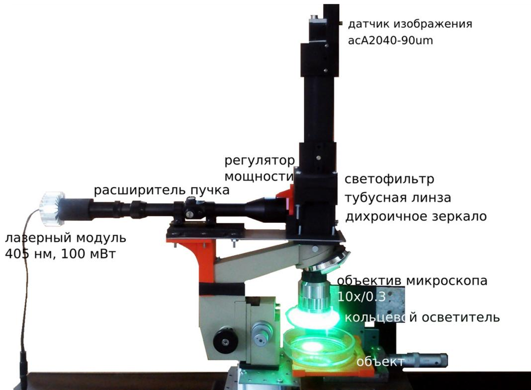
Рисунок 1.3: Экспериментальная установка.
