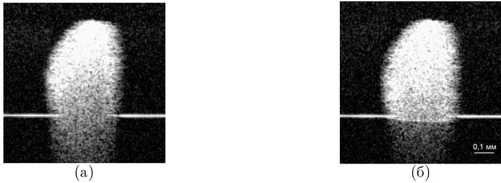
Рисунок 4.6. ОКТ-изображения образца вторичного сухожильного пучка, полученные при ориентации плоскости преимущественной поляризации падающего излучения параллельно (а) и перпендикулярно (б) оси сухожильного пучка.
