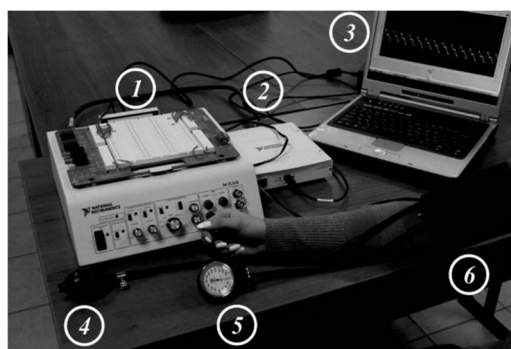
Рис. 3.1. Общий вид установки для регистрации пульсовой волны: 1 – лабораторная настольная станция «NI ELVIS»; 2 – «DAQmx»; 3 – ноутбук; 4 – резиновая груша; 5 – манометр; 6 – манжета со встроенным датчиком давления
