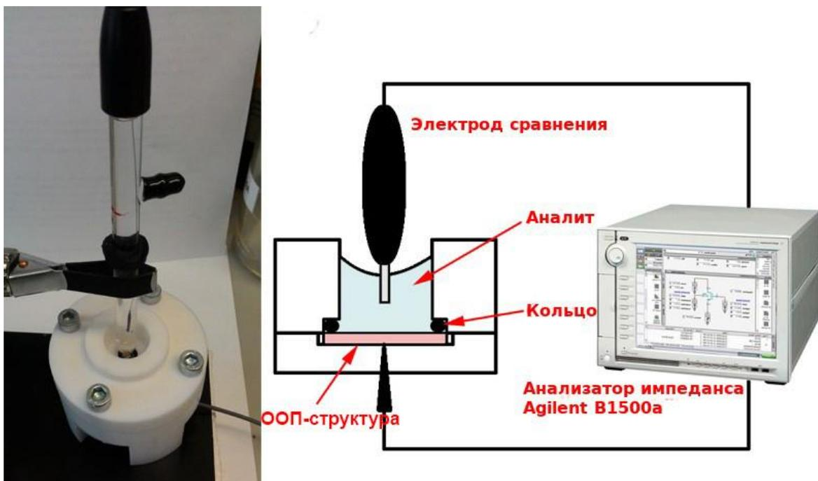
Рисунок 4.1 – Фотография внешнего вида электрохимической ячейки (слева), а также её схематическое изображение (справа)
