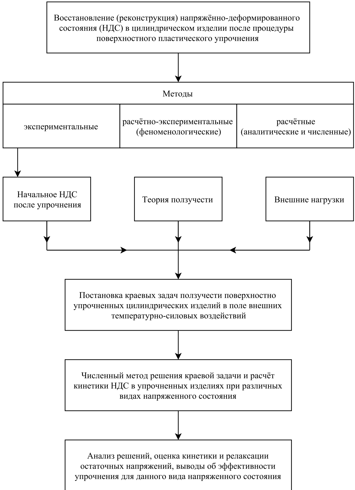
Рис. 1.1. Алгоритм исследования релаксации остаточных напряжений в упрочнённых цилиндрических изделиях в условиях ползучести
