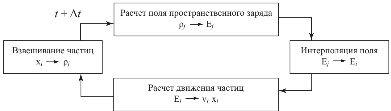
Рис. 1.4: Алгоритм численного моделирования электронного пучка в рамках метода крупных частиц.
