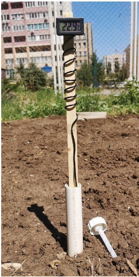
Рис. 1.13 Установка электронного термометра с выносным датчиком температуры ESPADA TPM-10
