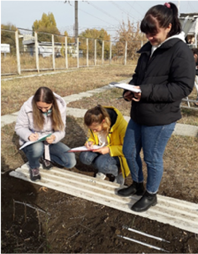
Рис. 1.7 Наблюдения за температурой поверхности почвы и температурой почвы на глубинах 5-20 см с помощью Савиновских термометров на учебной метеорологической станции СГУ
