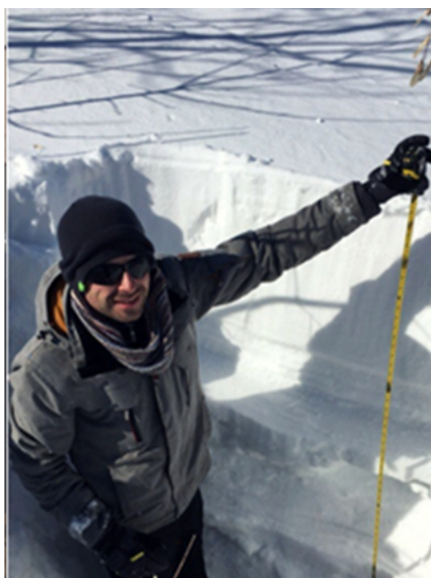
Рис. 5.10 Определение высоты снежного покрова с помощью рулетки
