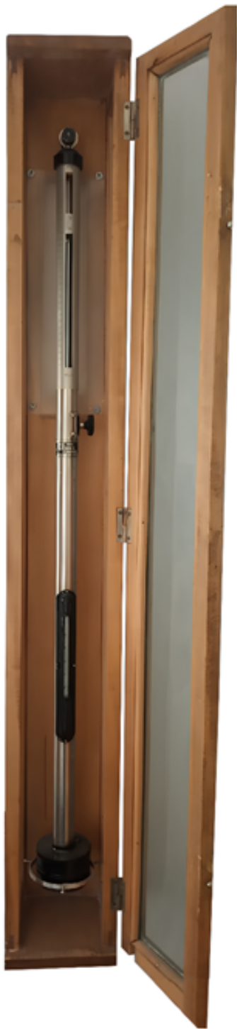
Рис. 3.10 Размещение барометра в специальном шкафчике на метеостанции
