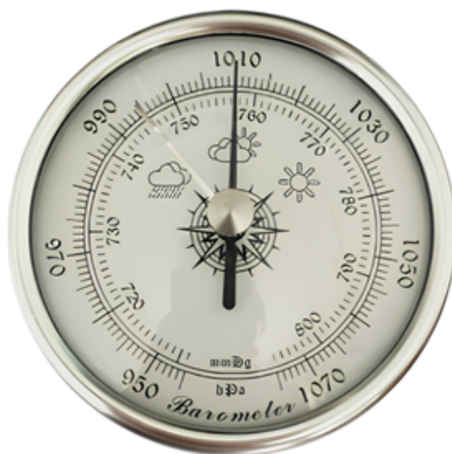
Рис. 3.16. Аналоговый anerоидный барометр
