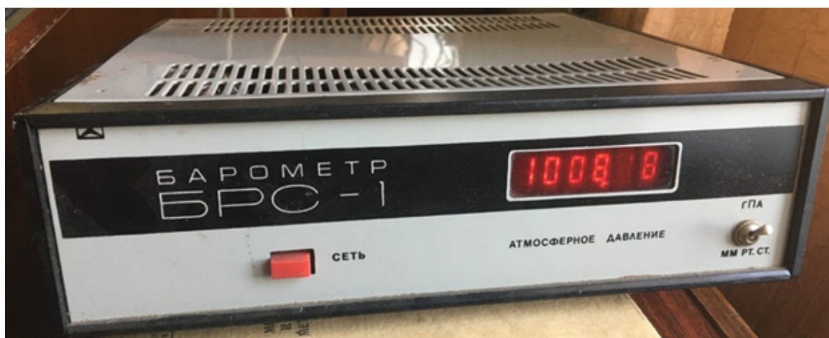
Рис. 3.12 Барометр рабочий сетевой БРС-1 на метеостанции «Саратов Ю-В»
