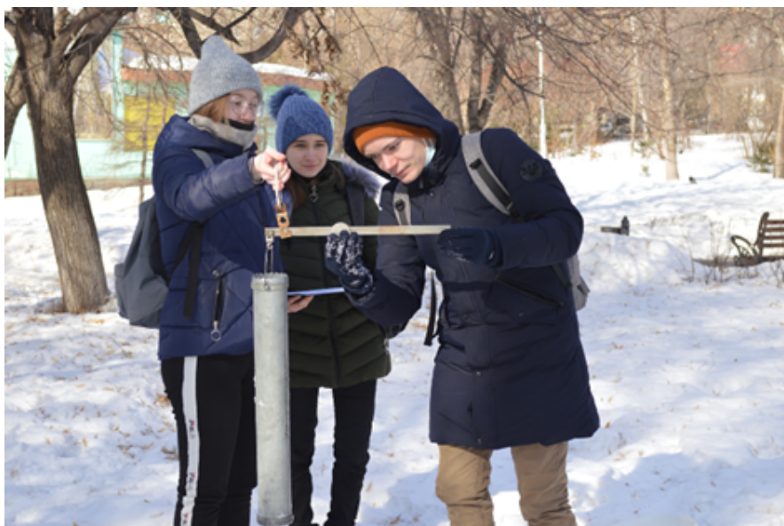
Рис. 5.3 Взвешивание пробы снега с помощью весового снегомера
