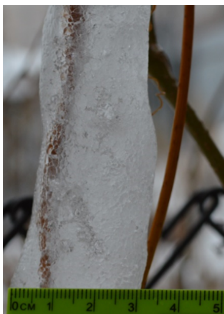
Рис. 5.15 Определение размера отложения с помощью линейки
