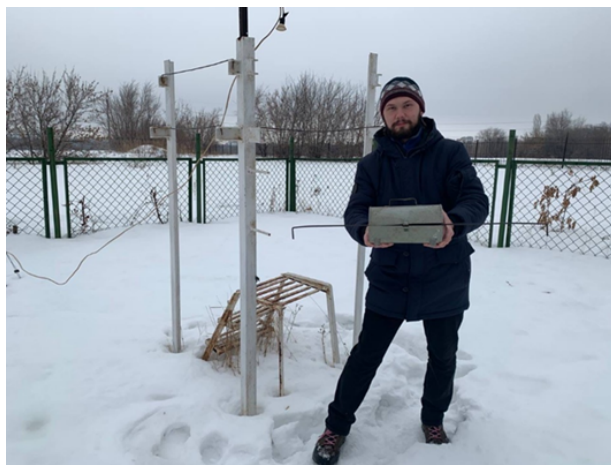
5.6 Измерения отложений с помощью гололедного станка на метеостанции Саратов Юго-Восток. Фото Михайлов Александр
