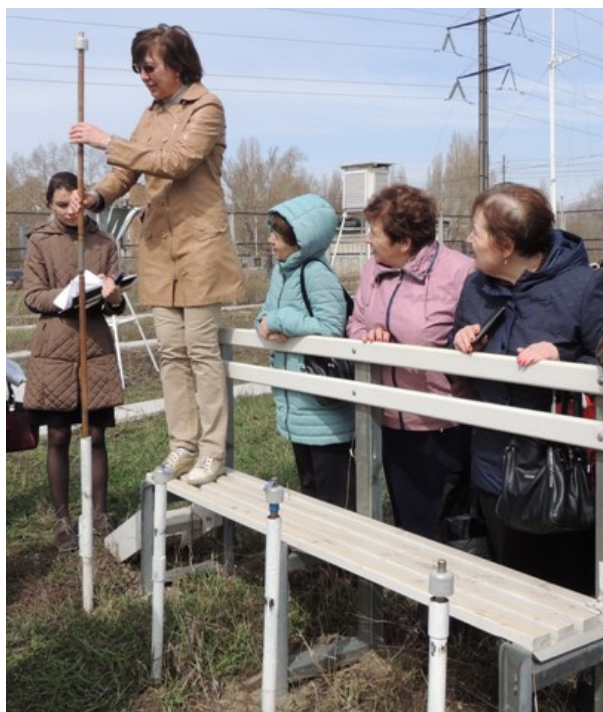
Рис. 1.11 Отсчет показаний по вытяжным термометрам на учебной метеорологической станции СГУ
