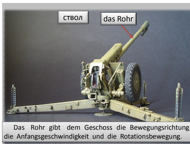
Рис. 4. Назначение механизмов орудия
