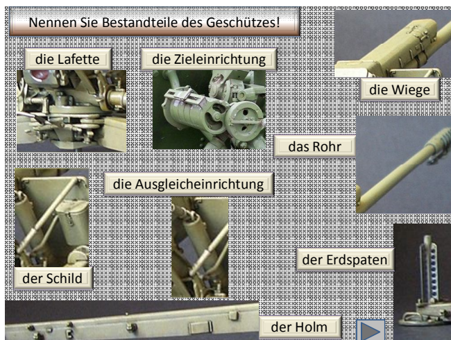
Рис. 5. Составные части и механизмы орудия
