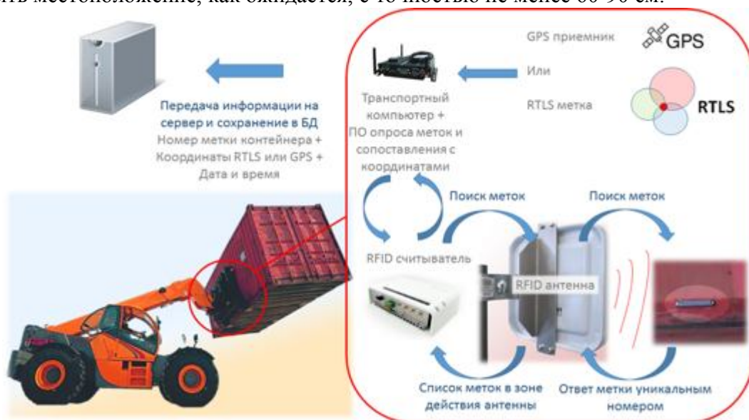
Рисунок 2 Структурная схема работы системы регистрации контейнеров
