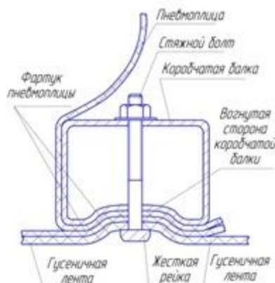
Рисунок 5. Устройство для крепления пневмоплиц к гусенице
