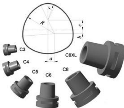
Рис.1. Конструкция и размеры конусов Capto [1]
