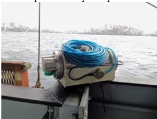
Рис.2а. Герметичный модуль спектрометра ЛИФ для ТНПА
