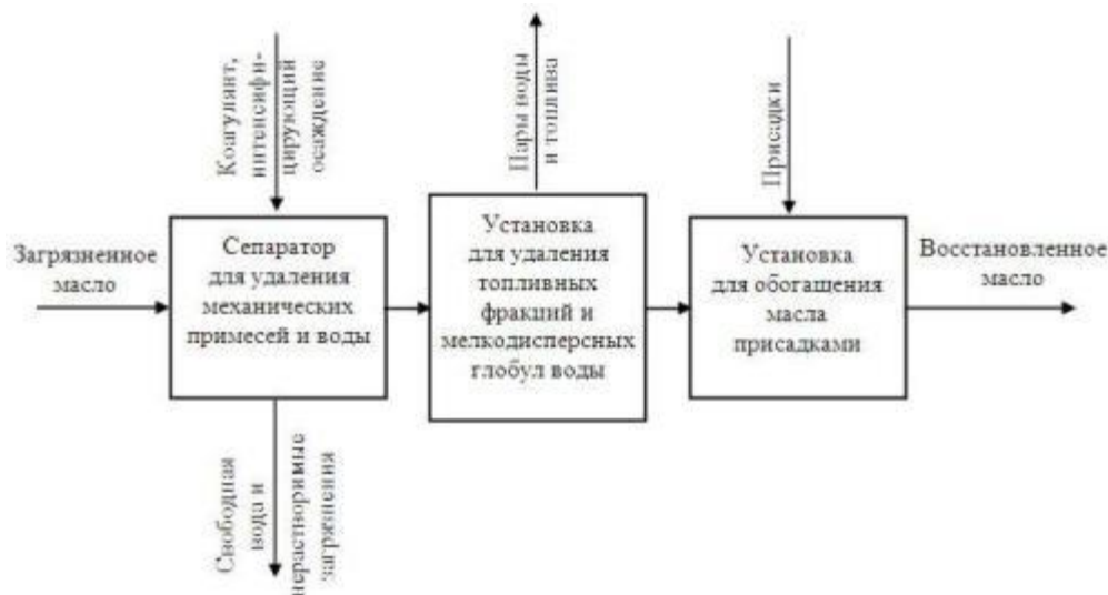
Рисунок 1 Схема регенерации и восстановления отработанного ММ
