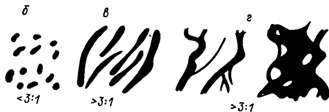
Рис. 4.20. Обычные формы песчаных тел (по Ф. Петтиджону, П. Поттеру, Р. Сиверу [1976]).
